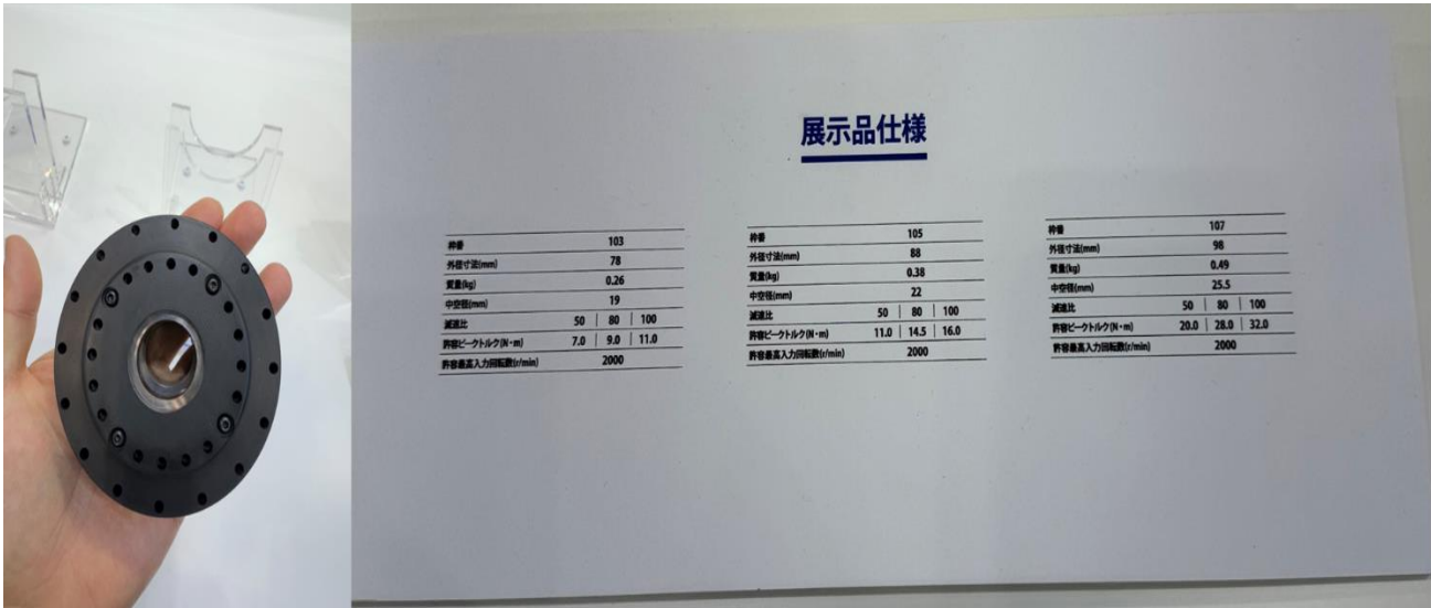
图6：住友展示超轻量化高强度谐波减速器，质量显著下降
