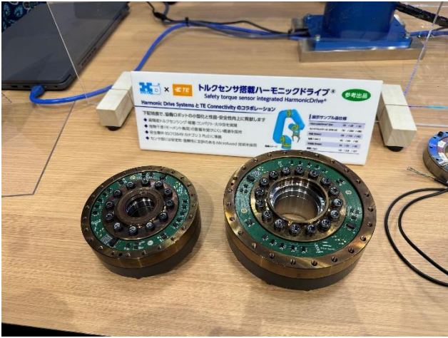
图4：哈默纳科产品开发关注减速器与驱动伺服一体化
