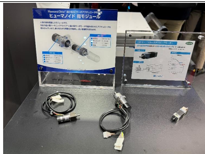
图3：哈默纳科微型谐波减速器分为 RSF 和 CSF 两大系列
