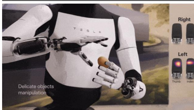
图12：特斯拉二代人形机器人指尖新增触觉传感器
