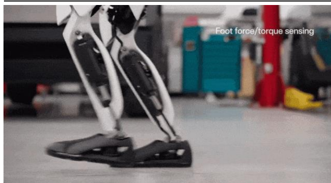
图13：特斯拉二代人形机器人脚部新增力矩传感器
