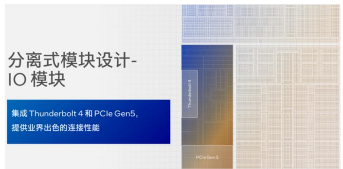
图 41: Meteor Lake IO 模块设计
