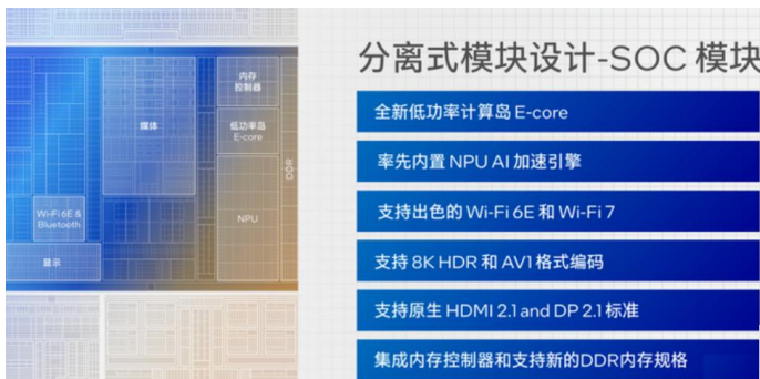
图 36: Meteor Lake SoC 模块化设计
