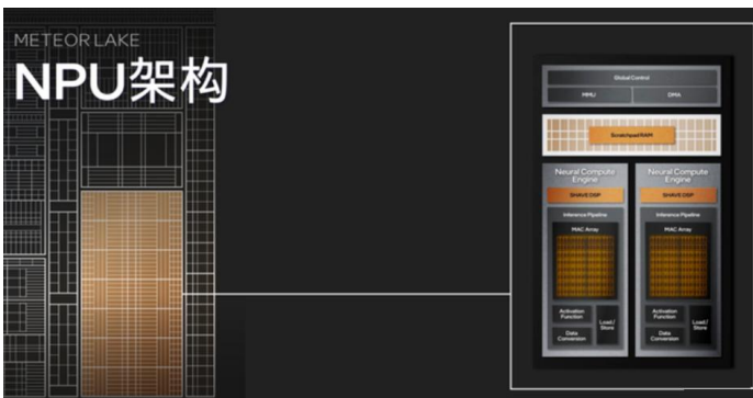
图 38: Meteor Lake NPU 架构
