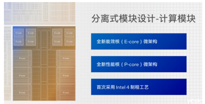
图 35: Meteor Lake 计算模块
