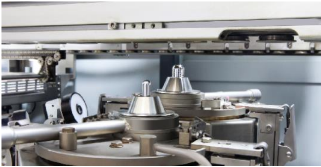
图35 快克智能焊接设备中的双电磁泵系统
