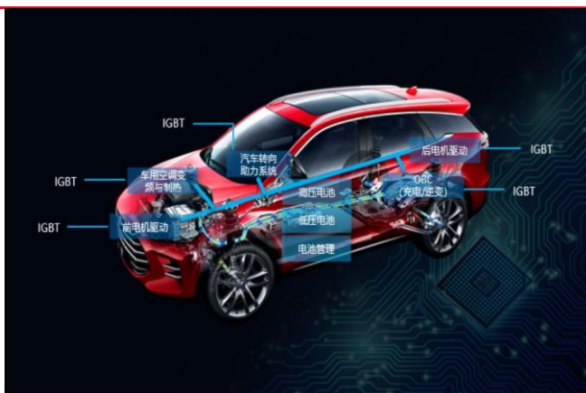
图46 新能源汽车 IGBT 分布示意图
