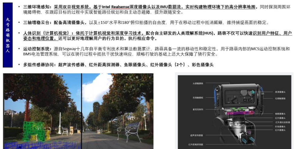
图15: 路萌机器人采用深度摄像头+IMU 技术, 避障辅以超声波传感器, 引入计算机视觉技术可识别人体数据
