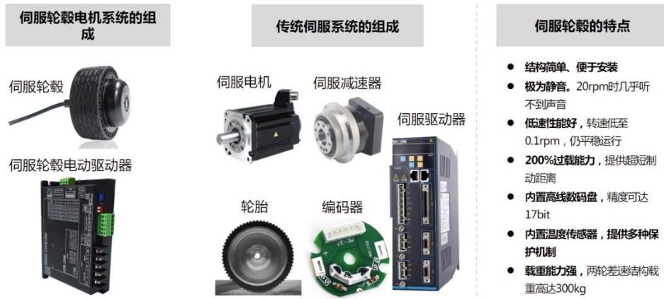
图8: 伺服轮毂电机凭借力矩大、惯量大、噪声小等特性更加适合服务机器人
