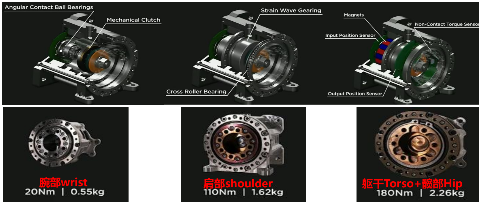
图 特斯拉Optimus旋转执行器结构及种类：由电机驱动器+无框伺服电机+谐波减速器+离合器+力矩传感器+编码器组成
