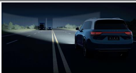
图1：问界 M9 ADB 功能控制照明区域
