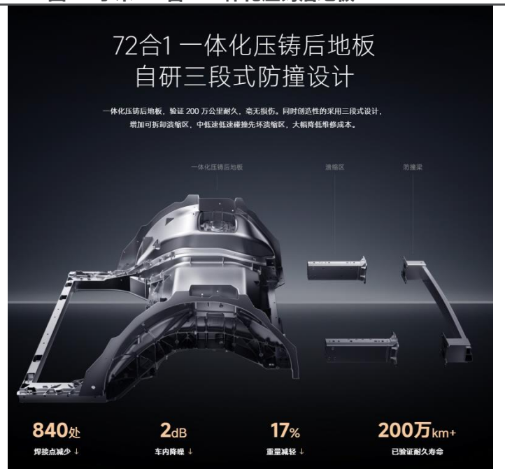
图3：小米 72 合 1 一体化压铸后地板
