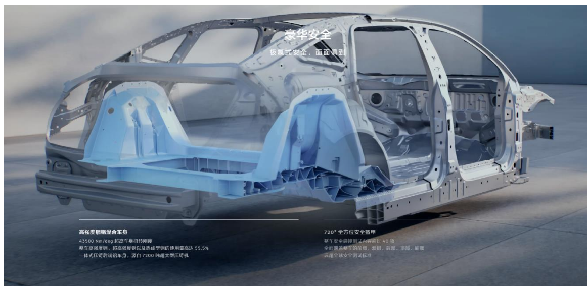
图6：极氪 007 一体式压铸后端铝车身
