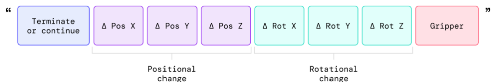
图表10：机器人动作表达为文本字符串可完成视觉-语言-动作数据协同微调
