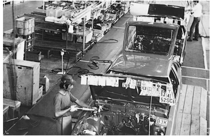
图表21: 丰田工厂通过车体上的纸张看板发出生产指令
