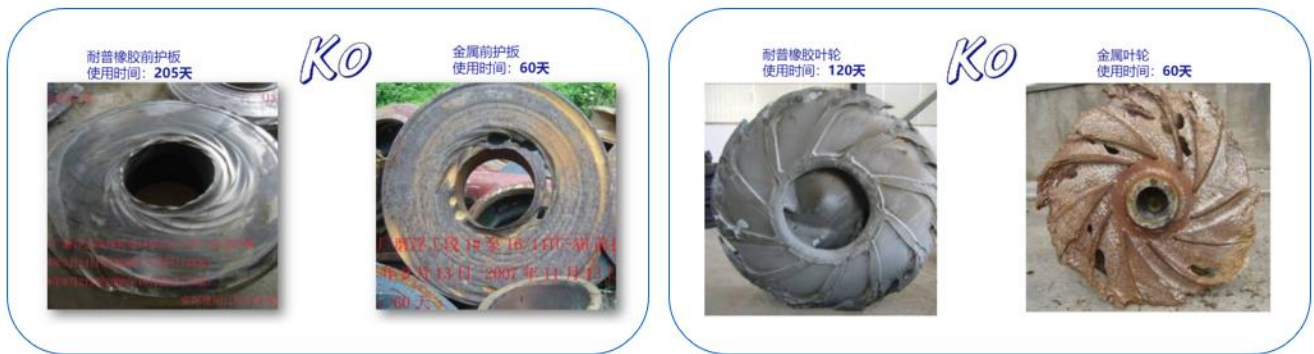
图表 4：耐普矿机江铜大山选矿厂 350 口径渣浆泵过流件使用案例
