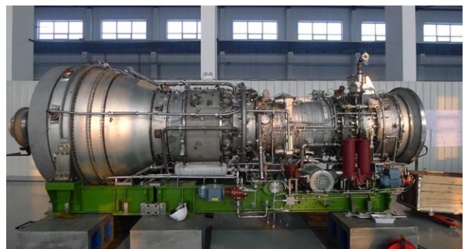
图 23：25MW 级工业型燃气轮机
