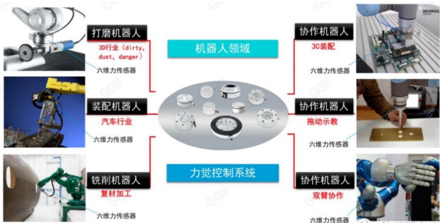
图表28：六维力传感器在机器人领域的应用
