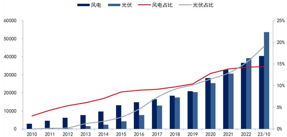
图9: 国内风电光伏装机容量及占比情况 (单位: 万千瓦)
