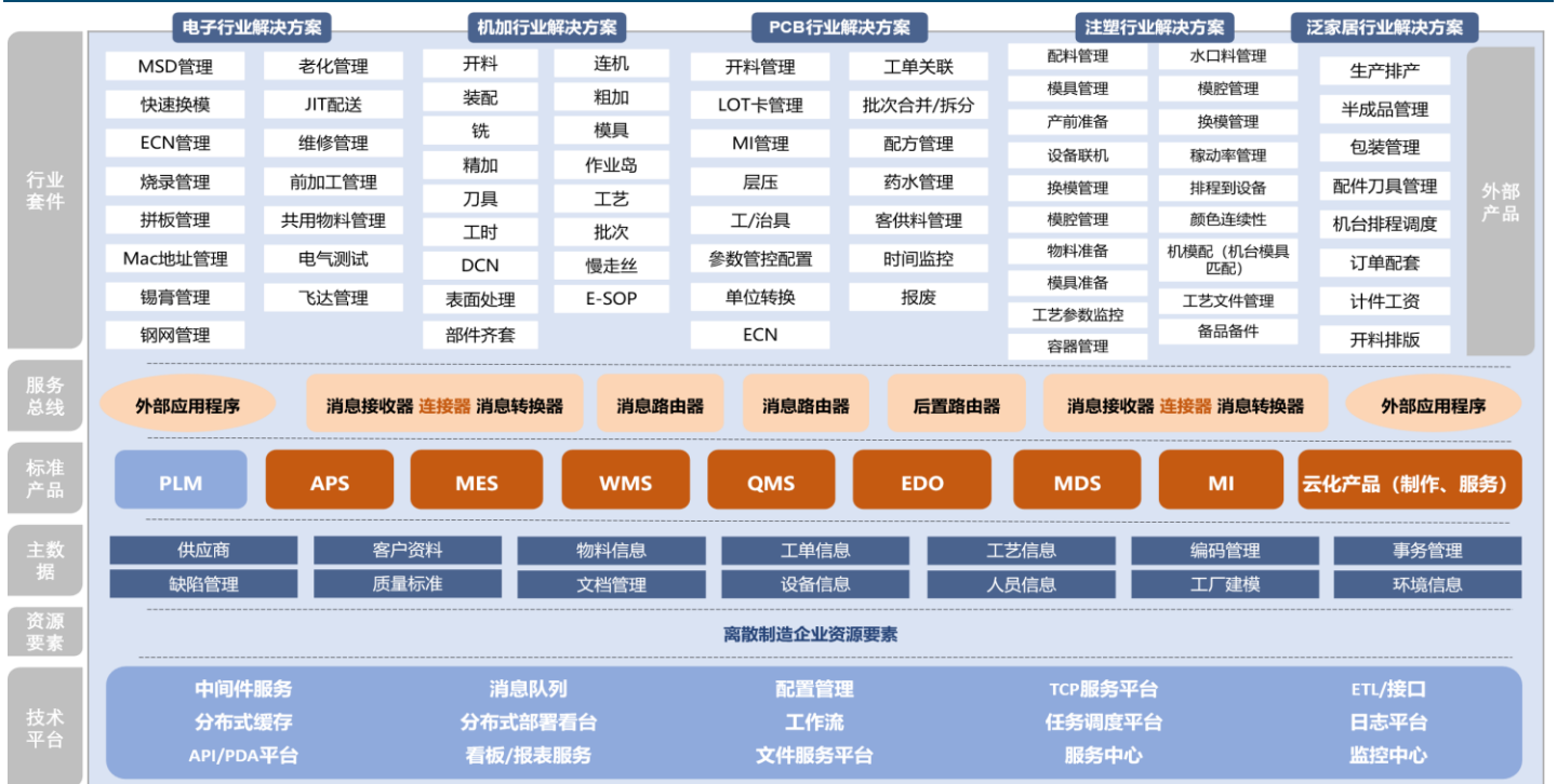
图表3: S-MOM 智能制造套件整体架构图
