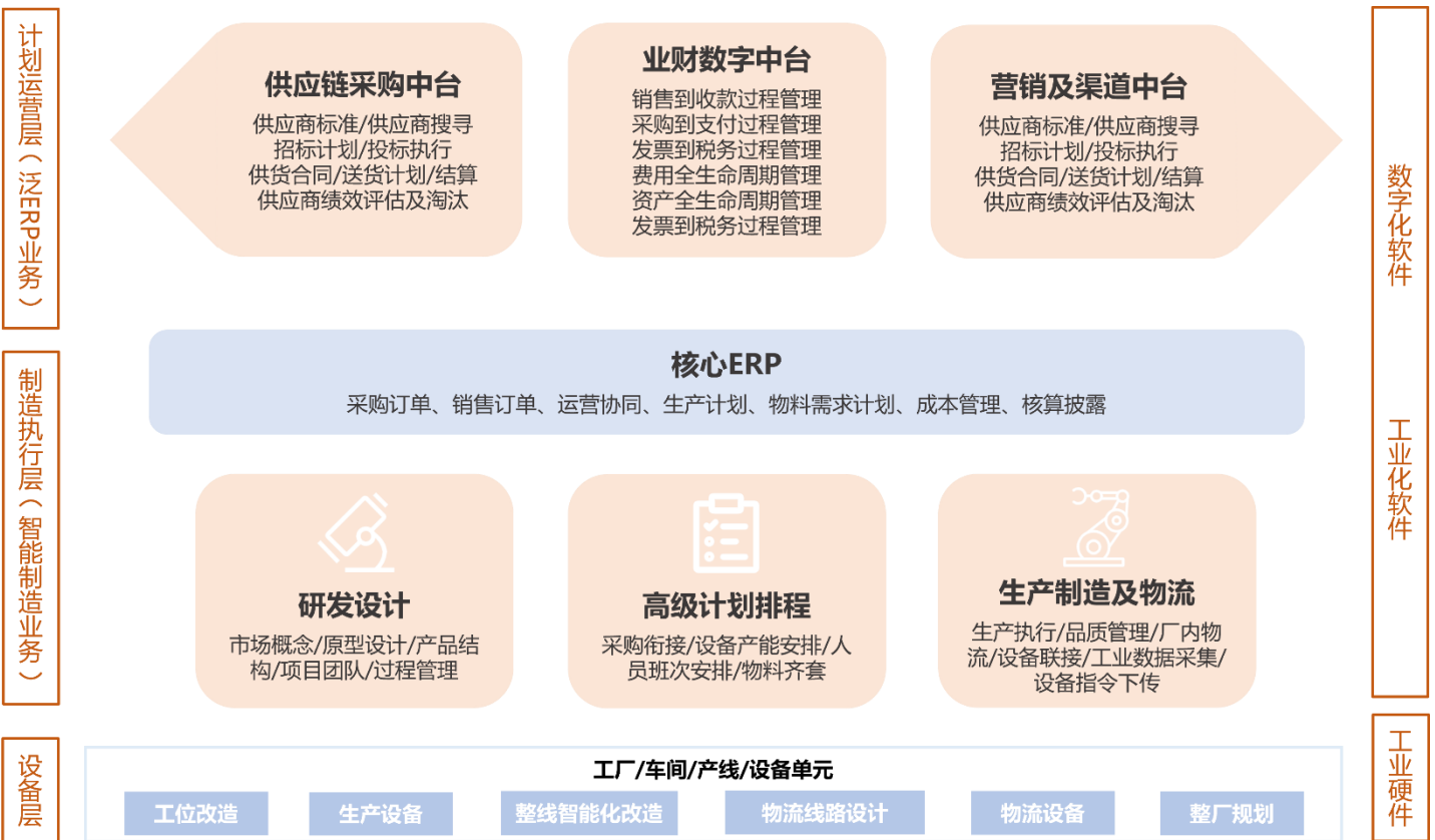
图表32: 核心 ERP+ 供应侧协同+智造协同+需求侧协同=全面智造水平提升
