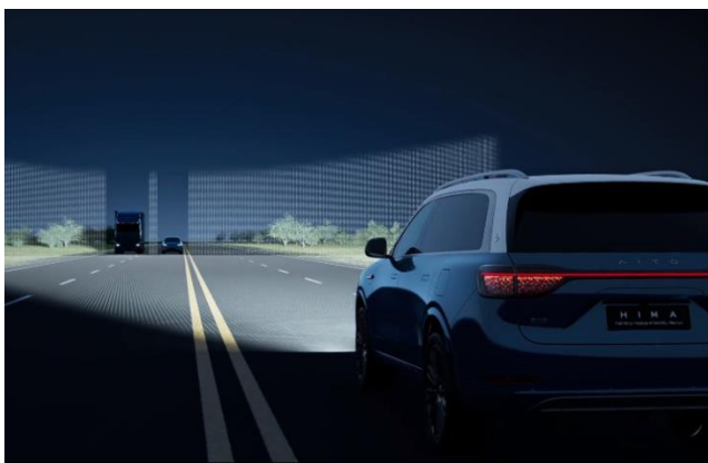
图6 ADB 自动遮蔽，远光不炫目
