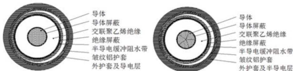
图3：球冠电缆 220kV 交联聚乙烯绝缘电力电缆产品结构示意图（单品举例）
