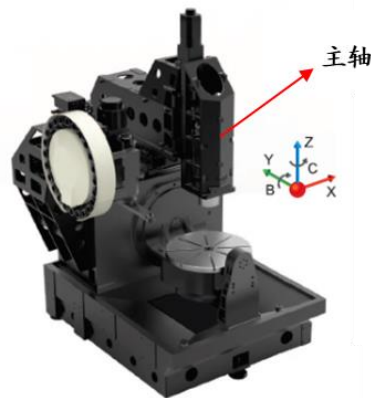
图61：主轴带动刀具或工件旋转
