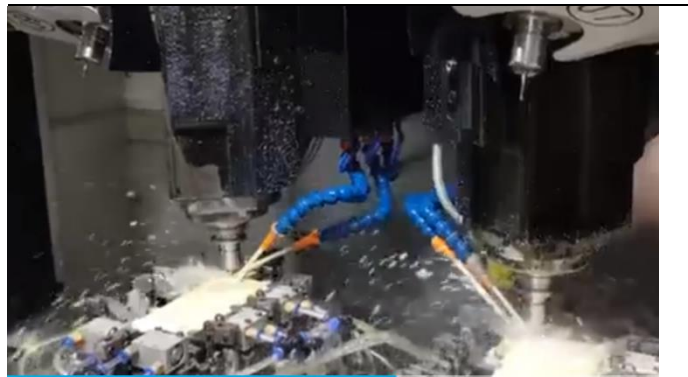
图17: 钻攻中心加工手机外壳
