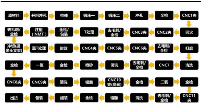
图16: 铝合金手机边框制程需要大量配套 CNC 机床
