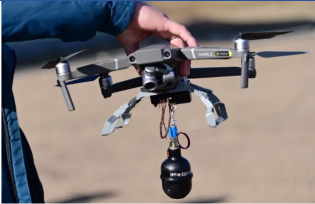
图表 42: 消费级无人机挂载手榴弹、炮击炮弹等小型弹药
