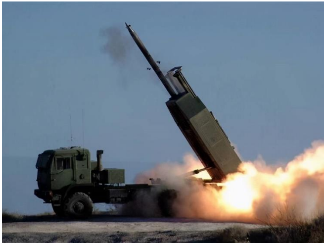
图表 17：“海马斯”火箭炮发射制导火箭弹
