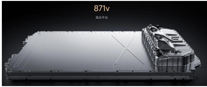
图 7 小米 800V 碳化硅高压平台
