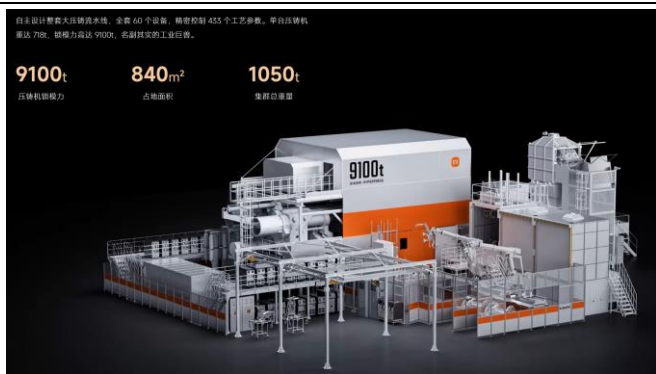
图 11 小米全链路自主设计大压铸设备集群系统
