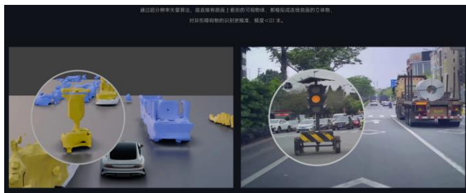
图 15 “超分辨率” 占用网络技术精确识别异形障碍物
