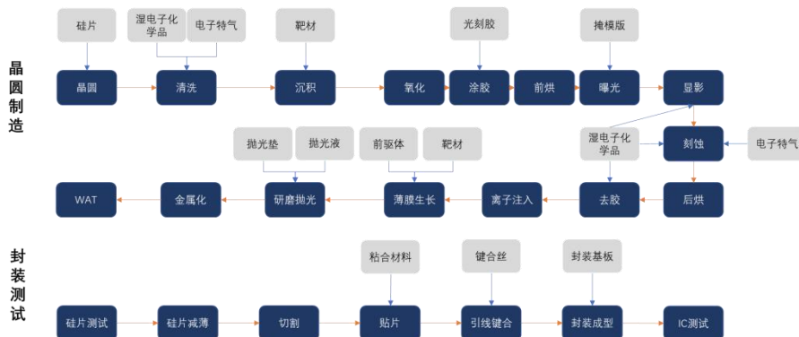
图 157：半导体制造环节流程及半导体材料应用
