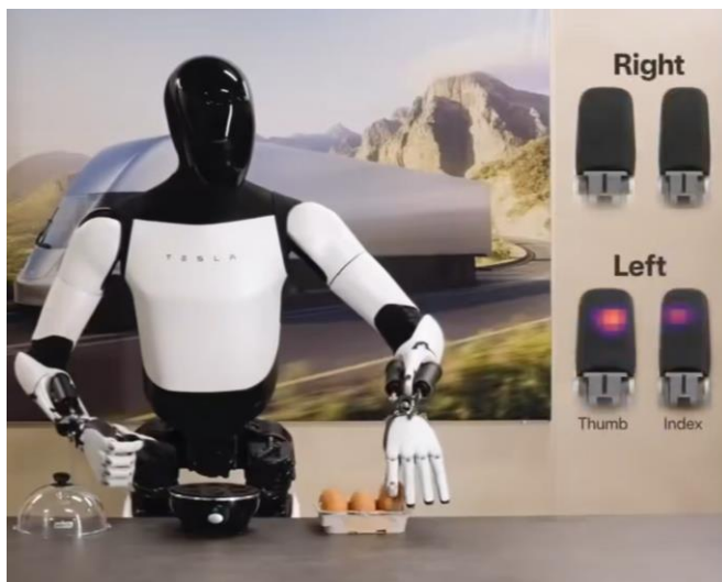
图. 手指末端增加触觉传感器，可以煮鸡蛋
