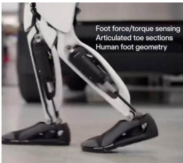
图. 脚部增加力传感器、足部仿生式设计
