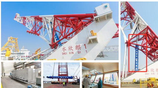
图53 恒立最大水上打桩设备液压油缸
