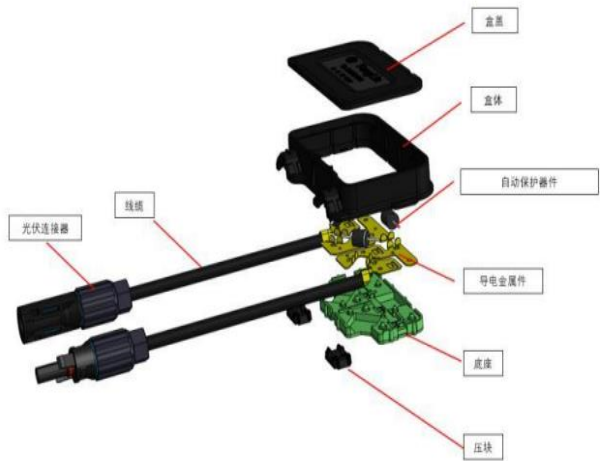
图表 13：光伏接线盒结构图
