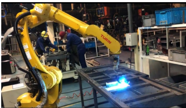
图19: 新能源重卡驾驶室焊接
