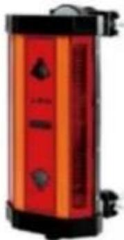
激光探测器是一种激光定位传感器，与激光扫平仪及控制器配套使用，可指示激光线或激光面的位置信息，广泛应用于建筑工程测量、农业土地整平、沟渠开挖施工等场景。
