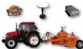
卫星导航定位系统由基准站、移动站、控制器组成，通过卫星信号提供水平位置信息、控制器控制机械设备作业刀具的高度位置；该系统同时兼容北斗卫星导航系统/GPS/GLONASS，主要应用于精准农业作业、整平作业和数字化施工作业。
