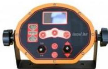
激光控制器是控制机械设备作业刀具动作的单元模块，通常与激光扫平仪和激光探测器配套使用，具有输出兼容性，采用比例控制阀。激光扫平仪的激光面作为作业基准，激光探测器安装在机械设备上，将接收到的激光信息传输至控制器，控制器发出指令控制智能装备的机械作业部位，使智能装备在保持作业时实时同步基准指标，达到智能控制高效施工的目的。
