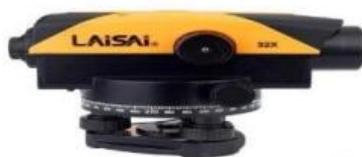
该系列产品主要指高精度自动安平水准仪，是一种通过建立水平视线测定地面两点间高差的仪器，主要应用于国家一等水准测量、建筑工程测量、地面沉降监测、大型机器安装等。每公里往返标准偏差：0.0015mm、放大倍率：32倍、补偿安平精度：±0.3”。
