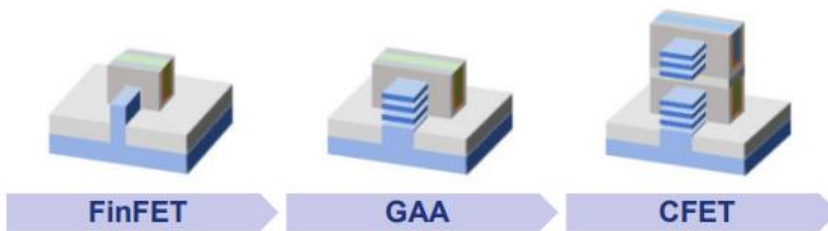
图9：器件结构由 FinFET 到 GAA，再到 CFET
