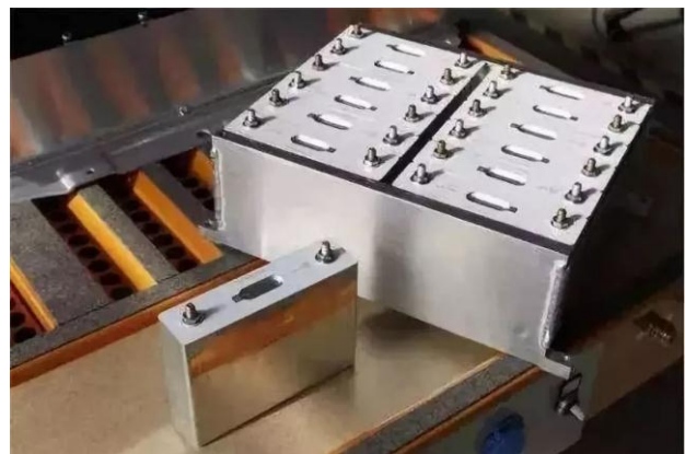
图 12：方形铝壳封装结构
