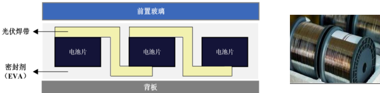
图1：光伏焊带工作原理及焊带产品图
