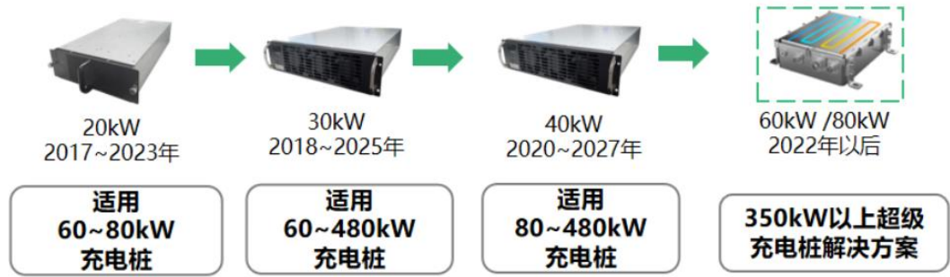
图表 45：高倍率+高压趋势下，充电桩需往大功率方向演进
