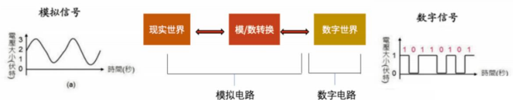
图16: 从现实世界到数字系统：模拟信号和数字信号的相互转变
