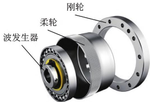
图表3 谐波减速器结构
