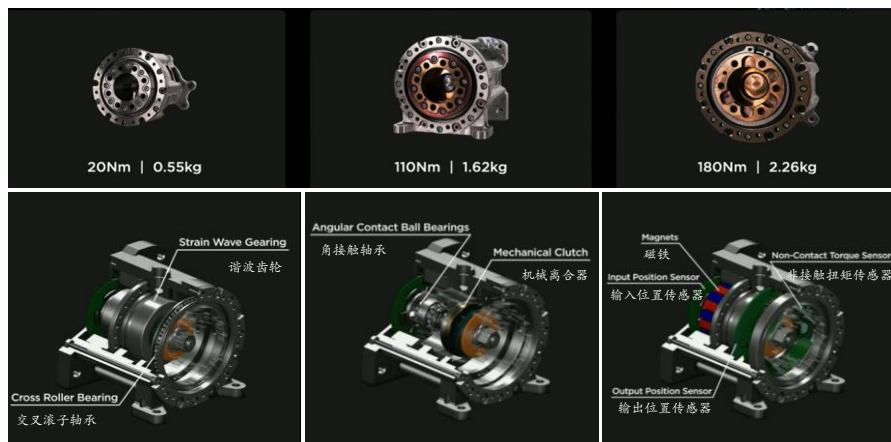
图表43 Optimus的3种旋转执行器方案图示
