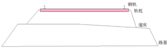
图表 61. 有砟轨道结构
