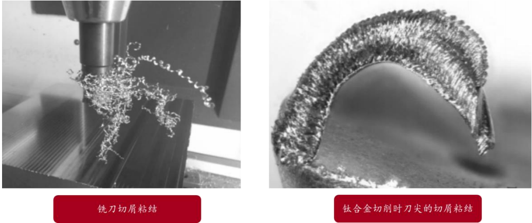
图表 22. 钛合金在 CNC 加工时易发生切屑粘结
