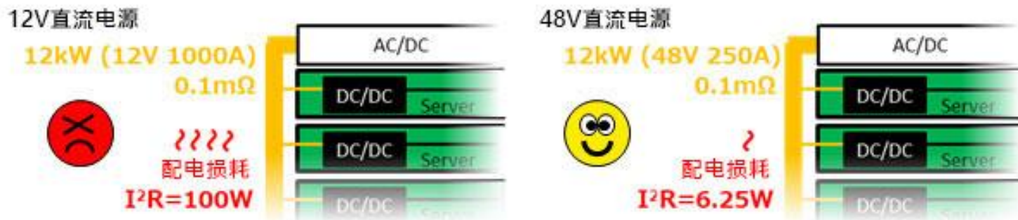
图：供电电压差异引起的损耗比较
