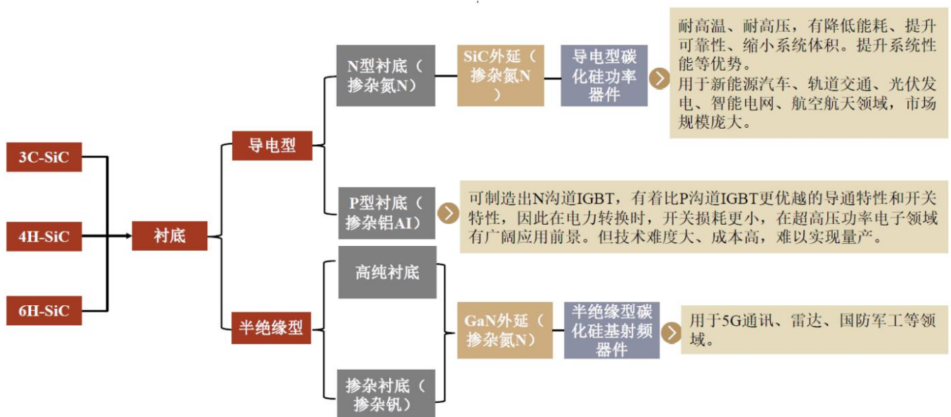
图 11：碳化硅材料及器件的主要形式划分
