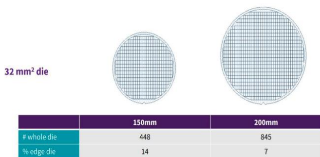
图 26：8 英寸衬底将提高晶圆利用率
