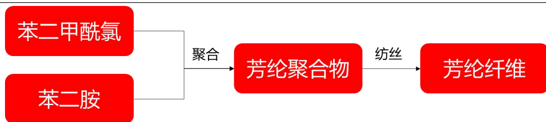
图 51：芳纶生产工艺流程
