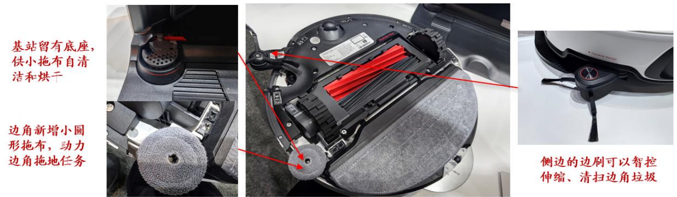
图11: 石头 S8 旗舰新品的边角清洁采用机械臂“边刷”外扩+额外的边角拖地系统
