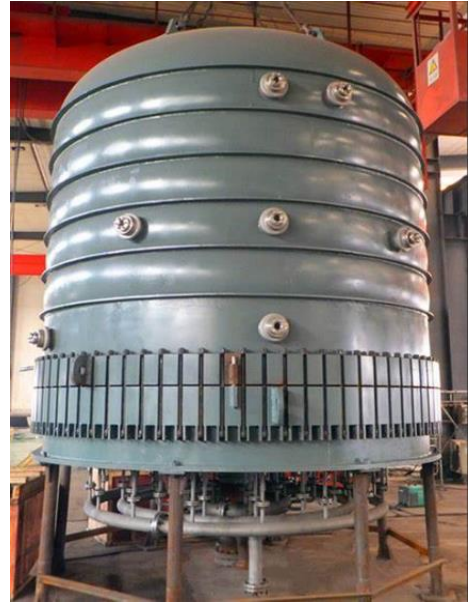
图 8：多晶硅还原炉反应器外部结构图
