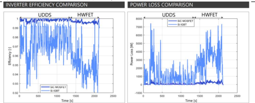
图表 59: SiC 和硅基 IGBT 逆变器效率对比
