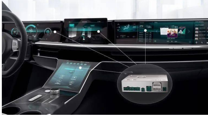
图表 34：座舱域控制器可逐渐实现一芯多屏、多屏互联等功能
