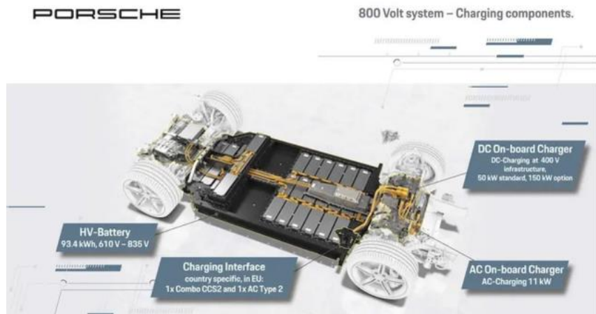
图表 46：保时捷率先推出 800V 高电压电气架构
