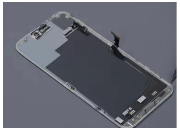
图30: iPhone15 屏幕背面覆盖大面积散热膜
