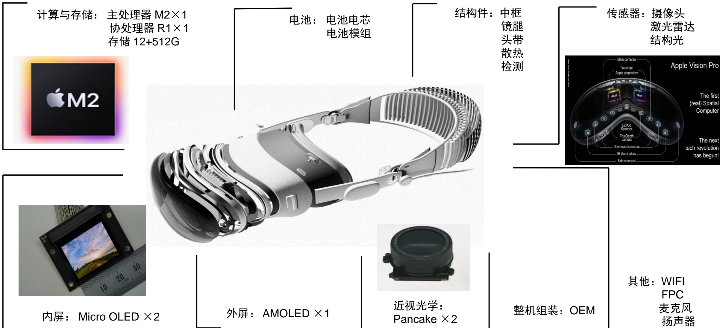
图表: Apple Vision Pro 主要部件拆解示意图
