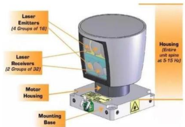
图 18：激光雷达构成
