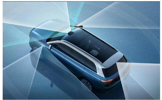
图表2：问界 M9 搭载 1 颗 192 线束激光雷达
