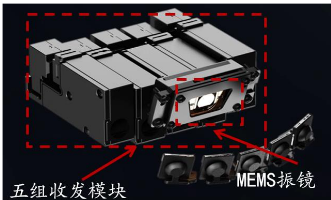
图表16: 速腾聚创 M1 内部结构
