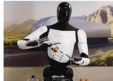
2023年12月特斯拉发布视频, Optimus-Gen2亮相, 体重减轻, 自由度增加, 运动能力、平衡性、感知能力提升
