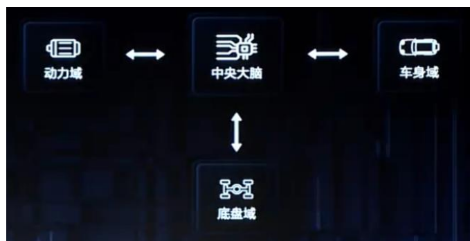
图表 4：璇玑采用中央控制+域控制的架构
