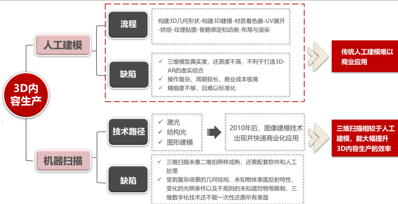
图12: 3D 内容有人工建模和机器扫描两种生产方式
