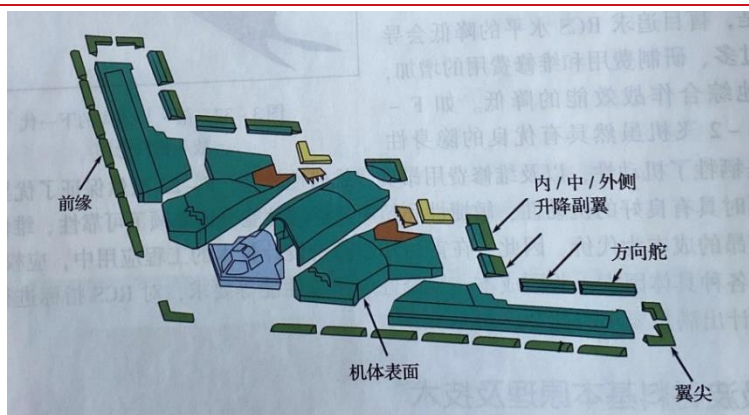
图表22：B-2 飞机吸波材料应用情况
