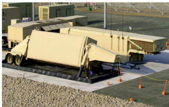
图表23: AN/TPY-2 中频数字相控阵雷达
