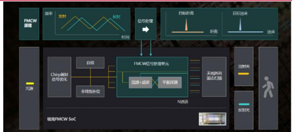
图表8：激光雷达中高集成度收发一体的硅光 FMCW SoC 架构
