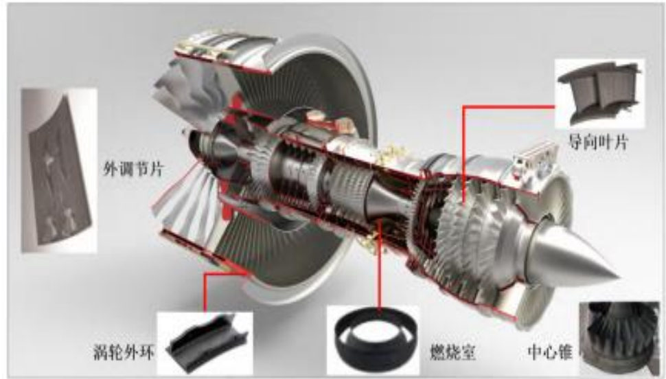
图 29：陶瓷基复合材料在先进航空发动机中的典型应用部位
