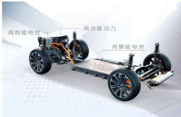
图表71: 长安智电 iDD 混动系统
